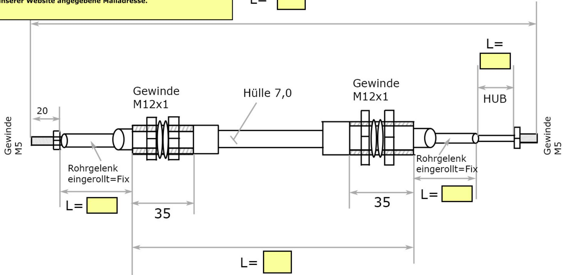
Type E: Innenseil 2,0 Flachwendel-NIRO / Hülle Aussen 7,0 / Betriebslast max N: ZUG 350 DRUCK 170
